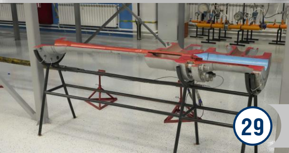
Учебное наглядное пособие эжектор системы низкотемпературной сепарации газового конденсата
