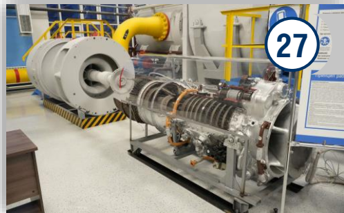
Учебное наглядное пособие газотурбинный двигатель AI-20
